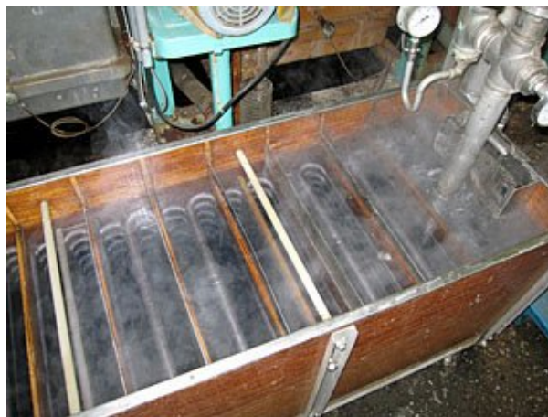
熱交換器エコメリット * 水槽は低温廃液、S 字管は熱回収管
